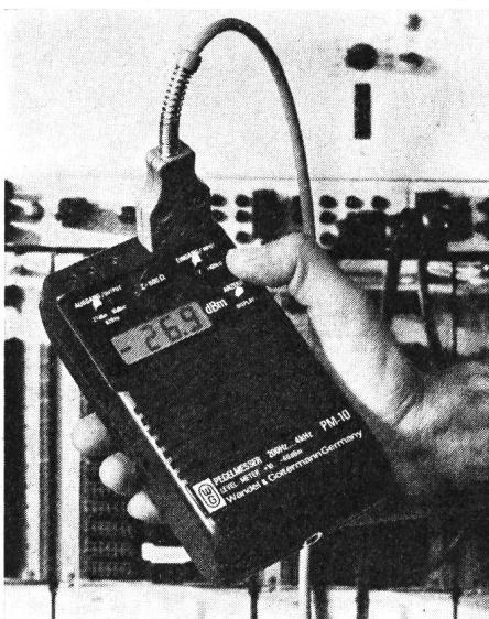
ablesbaren Flüssigkristall-Anzeige vorzeichenrichtig mit einer Auflösung von 0,1 dBm ablesen. Der Eingangswiderstand des Pegelmessers ist umschaltbar zwischen 600 Ω und  $\geq 100 \text{ k}\Omega$ , wobei der Eingang
