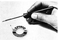
Lötspitze guter Lebensdauer. Die Lötnadeln in Niedervoltausführung mit Leistung von 6...12 W machen auch Schluss mit dem häufigen Löt-Tod von statisch empfindlichen CMOS-Bausteinen beim Löten mit Netzspannungs-Lötkolben. Hersteller der ECONO-Lötnadeln ist *Ernest Spirig*, 8640 Rapperswil, von wo auch die Lötsauglitze stammt.
