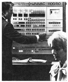
den wichtigsten Merkmalen zählen funktionell unabhängige Rechen- und Ein-/Ausgabe-Prozessoren, ein neuer, sehr schneller Pufferspeicher grosser Kapazität sowie ein Hauptspeicher, der bis zu einer Kapazität von 16 MBytes ausbaufähig ist.
