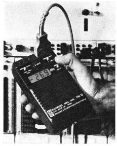
ablesbaren Flüssigkristall-Anzeige vorzeichenrichtig mit einer Auflösung von 0,1 dBm ablesen. Der Eingangswiderstand des Pegelmessers ist umschaltbar zwischen  $600 \Omega$  und  $\geq 100 k\Omega$ , wobei der Eingang
