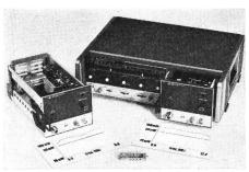
licht meist, das Sättigungsverhalten von Verstärkern und anderen aktiven und passiven Netzwerken ohne Verwendung von zusätzlichen röhrenbestückten Verstärkern zu untersuchen. Weitere Anwendungen sind die Ansteuerung von Antennen zur Messung der Charakteristik oder die Verwendung des Wobblers als Festoszillator zum Betreiben eines Mischers.
