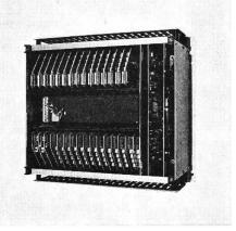
ausgerüstet, die ein direktes Ansteuern von Ventilen, Motorschützen usw. erlauben. 128 interne Relais gewähren dem Auto-Mate 31 zusätzliche Flexibilität zur Lösung allgemeiner und spezieller Steuerungsaufgaben.
