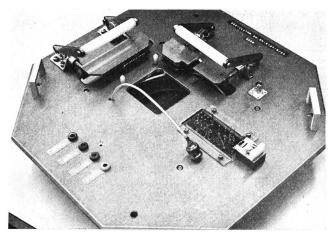
Fig. 4 Typischer Adapter für einen spezifischen Prüfling
