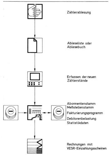
Fig. 3 Energiefakturierung mit Dialogsystem
