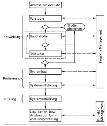
Fig. 1 Gliederung eines Datenverarbeitungsprojektes
