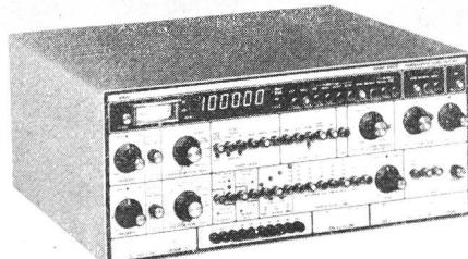
asymmetrisch begrenzt Sinus und Dreieck im Frequenzbereich von 20 Hz...100 kHz. Der Wobbelgenerator deckt 20 Hz...20 kHz mit 11 verschiedenen Wobbelgeschwindigkeiten von 1...1024 s. Der verzerungssame Ausgangsverstärker leistet +30 dBm in eine 600-Ohm-Last. Ein Attenuator von 10 dB per Stufe und ein
