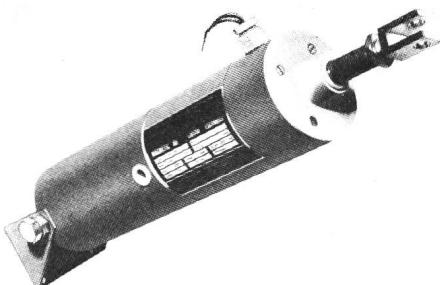
bar, wo eine Schub-, eine Schub- und Zug- oder nur eine Zugkraft benötigt wird. Die einzelnen Typen unterscheiden sich einzig in ihrer Leistung und Hublänge, die man der jeweiligen spezifischen Aufgabe optimal anpassen kann. Alle haben eine Nennspannung von 220 V, 50 Hz. Die Stromaufnahme reicht von 0,15 bis 2,7 A, die Leistungsaufnahme von 16 bis 550 W, das Gewicht von 0,5 bis 15 kg, die Kraft von 100 bis 6000 N. Bei Hublängen von 10 bis 400 mm betragen die Laufgeschwindigkeiten 3 bis 100 mm/s.
