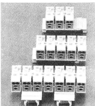
gen (Blechdicke 1 mm). Anschliessbare Querschnitte: 2 × 2,5 mm²/2 × 1,5 mm² je Potential. Klemmenteilung zwischen den Polen: 10 mm. Die Klemme ist geeignet für die Verdrahtung von Steuerleitungen in Zählertafeln.
