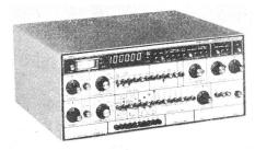
asymmetrisch begrenzt Sinus und Dreieck im Frequenzbereich von 20 Hz...100 kHz. Der Wobbelgenerator deckt 20 Hz... 20 kHz mit 11 verschiedenen Wobbelgeschwindigkeiten von 1...1024 s. Der verzerrungsarme Ausgangsverstärker leistet  $+30~\mathrm{dBm}$  in eine 600-Ohm-Last. Ein Attenuator von 10 dB per Stufe und ein
