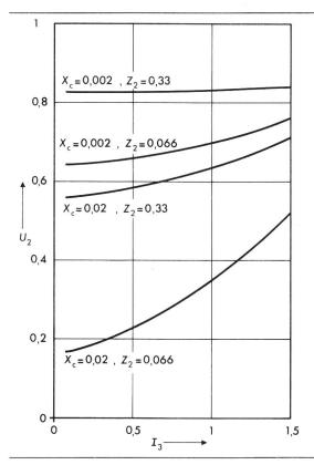
Fig. 4 Minimalwert der Sammelschienenspannung  $U_2$  (Spannungseinbruch)
