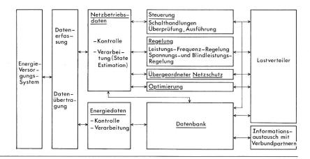
Fig. 1 Führungssystem eines Partners im Hochspannungs-Verbundnetz
