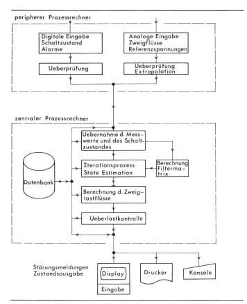
Fig. 2 Schematischer Ablauf des State-Estimation-Prozesses
