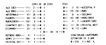
Fig. 4 Schaltanlage Laufenburg mit Schaltzustand sowie Wirkund Blindlastfluss der Leitungen und Transformatoren und Spannungen der Sammelschienen
