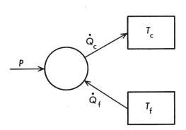
Fig. 1 Diagramme des flux d'énergie d'une pompe à chaleur
