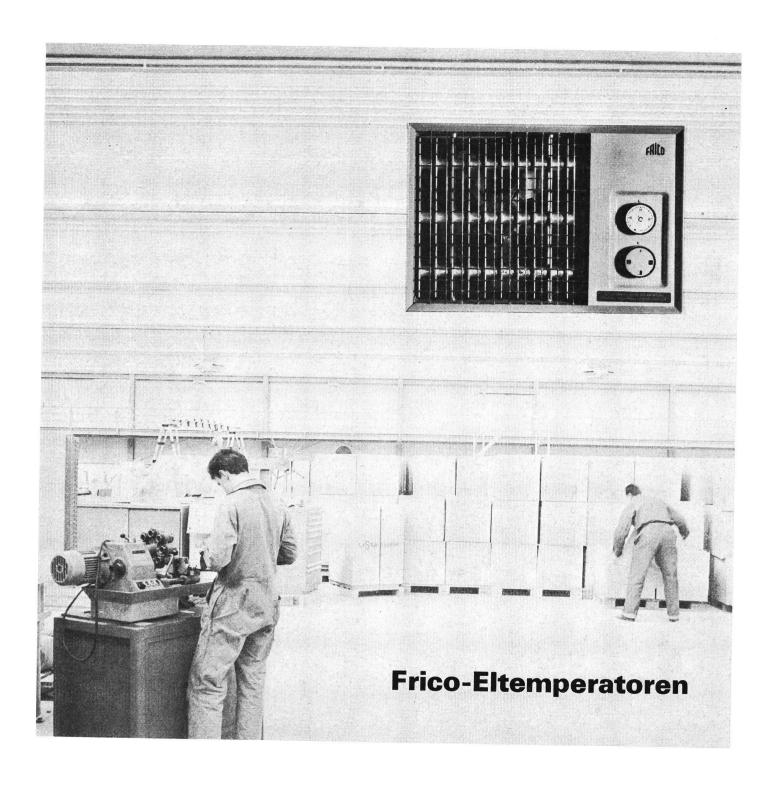
Warmluftheizgerät für Industrie und Gewerbe oder als Zusatzheizung im Wohnbau, mit Leistungen von 3 bis 23 kW. Geräuscharmer Ventilator. Keine Staub- oder Brennstoffgerüche dank gekapselter Heizelemente. Eltemperatoren an die Wand montiert, mit Frischluftanschluß über Luftmischer mit verstellbaren Klappen, zusammen mit Luftrichtgerät und Raumthermostat ermöglichen den Einsatz als Klimagerät. Bitte verlangen Sie unsere ausführliche Dokumentation Frico- Eltemperatoren.
