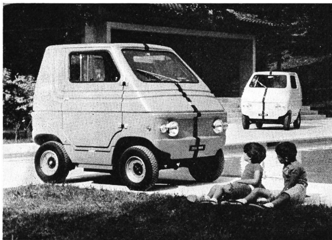
Fig. 2 Zele 1000 (in den USA Elcar genannt) Hergestellt in Italien und in den USA Max. Geschwindigkeit: 40 km/h Reichweite pro Batterieladung: max. 80 km
