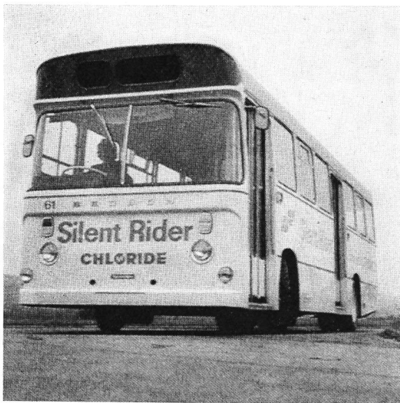
Fig. 5 Stadtbuss «Silent Rider», entwickelt von der Akkumulatorenfabrik Chloride in Zusammenarbeit mit SELNEC, einer britischen Transportunternehmung Max. Geschwindigkeit: 65 km/h Transportkapazität: 50 Personen Reichweite pro Batterieladung: 65 km
