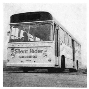
Fig. 5 Stadtbus «Silent Rider», entwickelt von der Akkumulatorenfabrik Chloride in Zusammenarbeit mit SELNEC, einer britischen Transportunternehmung
