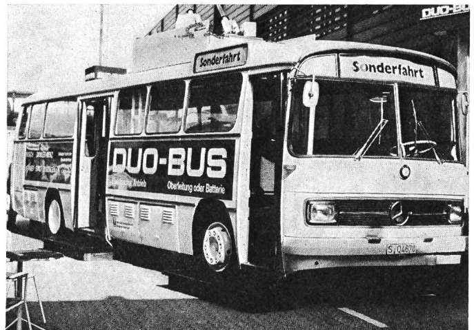
Fig. 14 Duo-Bus (Fahrleitungs- und Batteriebetrieb) Beförderungskapazität bis 100 Personen Höchstgeschwindigkeit: etwa 70 km/h Reichweite bei reinem Batteriebetrieb: 50–75 km
