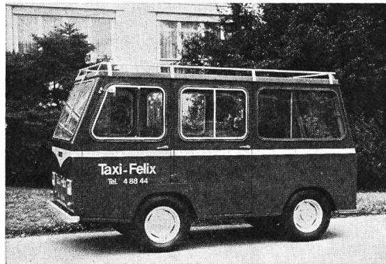
schen. Die 48-V/280-Ah-Traktionsbatterien von 700 kg machen rund die Hälfte des gesamten Fahrzeuggewichtes aus. Eine einfache Vorrichtung erlaubt es, die leeren Batterien relativ rasch gegen geladene auszutauschen. Das Elektrofahrzeug wird von 2 48-V-Seriemotoren von je 4 kW Nennleistung angetrieben, die über Thyristoren stufenlos gespeist werden. Es fährt sich wie ein gewöhnlicher Personenwagen mit automatischem Getriebe, wobei aber mit dem «Gaspedal» die Fahrgeschwindigkeit vorgegeben wird.
