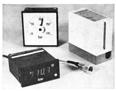
AN 2559 mit 3³/4 Stellen sind mit einer eingebauten Zusatzschaltung ergänzt worden, welche den Direktanschluss an piezoresistive Druckaufnehmer ermöglicht. Die eingebaute Konstantstromquelle liefert den Kalibrierstrom, das Ausgangssignal wird direkt dem Differenzverstärker des Digitalvoltmeters zugeführt. Mit den beiden Geräten stehen zwei, speziell für den Einsatz in Anlagen geeignete Bausteine zur Verfügung.
