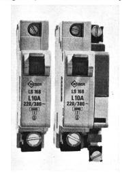
grenze wie L und V, magnetische Ansprechgrenze stark erhöht (Zählervorsicherung). Nennströme: 0,5 A...40 A; Nennabschaltvermögen bei 220 V/380 V $\sim I_{\rm n}=10$  A...32 A: 6000 A,  $\cos\varphi=0.7$ ; Grenzabschaltvermögen für  $I_{\rm n}=10$  A: 10~000 A,  $\cos\varphi=0.7$ .
