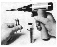
starken NiCd-Akkus ausgerüstet und kann auch zum Abwickeln verwendet werden. Mit einer Batterieladung kann bei AWG 30 ca. 8 h, bei AWG 24 ca. 4 h ohne Unterbruch gearbeitet werden. Die Batteriespannung beträgt 3 V. Diese niedrige Spannung ermöglicht das zerstörungsfreie Direktverdrahten höchstempfindlicher Bauteile. Zum Werkzeug ist auch ein Ladegerät lieferbar.
