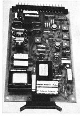
Drehzahl/Strom-Kaskadenregelung, Potentiometer für Maximaldrehzahl, Verstärkung Drehzahlregler sowie Strombegrenzung, eingebauter Feldgleichrichter, Europakartenformat mit DIN-Stecker oder Klemmenanschlüssen.
