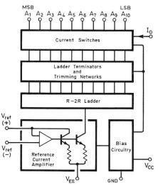
pufferverstärker und die Referenzspannungsschaltung sind weggelassen worden, um höchste Schnelligkeit, Flexibilität und niedrige Kosten zu erreichen. Daten der MC 3410-Serie: Linearität besser als  $\pm$  0,05 %; Einstellzeit typisch 250 ns; Standardversorgungsspannungen +5 V und -15 V; Ausgangsspannungen zwischen + 0,2 und -2,5 V. Alle digitalen Eingänge sind nicht invertiert und kompatibel mit MTTL- und CMOS-Bausteinen.
