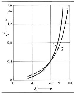
Fig. 8 Polradverluste bei Nenndrehzahl (Maschine A)
