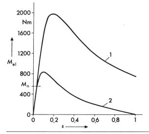
Fig. 9 Stationäres elektrisches Drehmoment  $M_{\rm el}$  der untersuchten Maschine als Funktion des Schlupfes s
