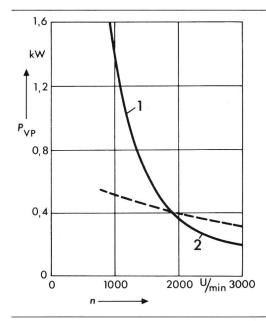
Fig. 9 Polradverluste bei Nennspannung (Maschine A)
