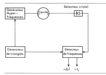
Fig. 1 Schéma bloc du système de mesure
