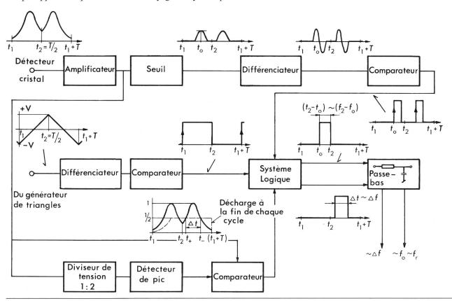
Fig. 2 Schéma bloc du détecteur de fréquence
