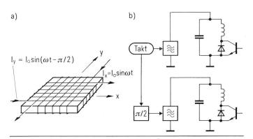
Fig. 8 Erzeugung des Rotationsfeldes mit gekreuzten Flachspulen (a), die in Schwingkreisen betrieben werden (b)
