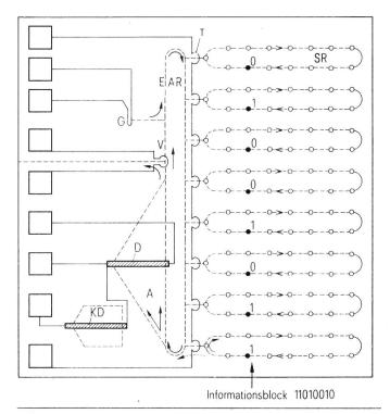
Fig. 4 Anordnung der Strukturen am Chip
