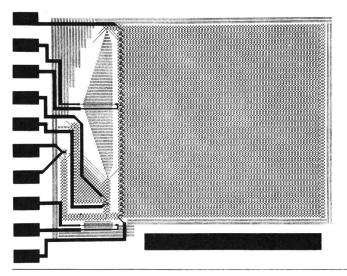
Fig. 6 Photographie eines 4-kbit-Chip Abmessungen ca. 2×1,5 mm
