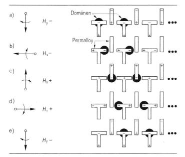
Fig. 2 Domänentransport durch T-I-Muster aus Permalloy
