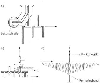
Fig. 3 Generator (a), Weiche (b) und Detektor (c)
