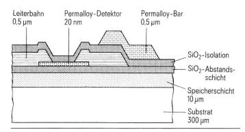
Fig. 5 Schichtfolge am Chip
