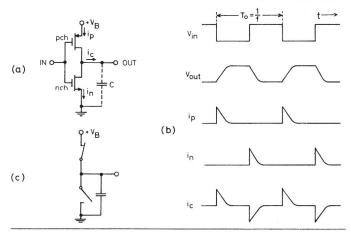
Fig. 2 Courant dynamique de l'inverseur CMOS
