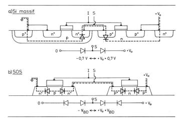
Fig. 7 Problème de la protection des sorties
