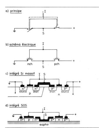
Fig. 1 Inverseur CMOS
