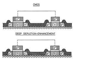
Fig. 5 Technologie SOS: comparaison entre CMOS et Deep Depletion-Enhancement
