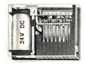
Das Printrelais wird für Nennspannungen von 6...110 V DC, mit je 2 Arbeits- und 2 Ruhekontakten geliefert. Schaltleistung 220 V $\sim$ /6 A. Kontaktmaterial ist Hartsilber. Die Abmessungen des Relais betragen 45  $\times$  36 mm, Bauhöhe 12 mm. Die Anschlüsse liegen im  $^{1}/_{10}$ "-Raster.
