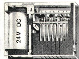
Das Printrelais wird für Nennspannungen von 6...110 V DC, mit je 2 Arbeits- und 2 Ruhekontakten geliefert. Schaltleistung 220 V ~/6 A. Kontaktmaterial ist Hartsilber. Die Abmessungen des Relais betragen 45 × 36 mm, Bauhöhe 12 mm. Die Anschlüsse liegen im  $\frac{1}{10}$ "-Raster.
