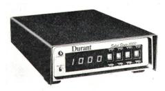
Die 4-, 6- und 8stelligen Summierer und der 4stellige Vorwahlzähler sind mit einer deutlich lesbaren LED-Anzeige ausgerüstet. Die Einstellung des Vorwahlzählers erfolgt mit Hilfe der tastenbetätigten, frontseitig angebrachten Codierschalter. Technische Daten des Vorwahlzählers:
