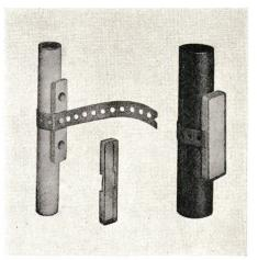
Basel, leicht umgehen. Diese praktischen Schilder bestehen aus einem weissen Kunststoffsockel mit Fixierzapfen, einem glasklaren Kunststoffdeckel mit eingelegter Etikette und dem Befestigungslochband aus flexiblem Kunststoff. SES-Fix-Bezeichnungsschilder sind in 3 Grössen lieferbar für Durchmesser ab 8 mm. Sie sind beständig gegen Spritzer von Säuren, Laugen, Öl und Benzin. Einsatztemperatur: –20...+60 °C.
