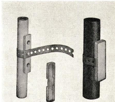
Basel, leicht umgehen. Diese praktischen Schilder bestehen aus einem weißen Kunststoffsockel mit Fixierzapfen, einem glasklaren Kunststoffdeckel mit eingelegter Etikette und dem Befestigungslochband aus flexilem Kunststoff. SES-Fix-Bezeichnungsschilder sind in 3 Größen lieferbar für Durchmesser ab 8 mm. Sie sind beständig gegen Spritzer von Säuren, Lauge, Öl und Benzin. Einsatztemperatur: -20...+60 °C.
