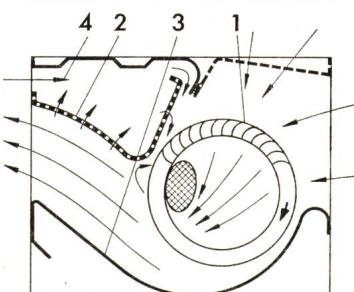
günstigen geometrischen Verhältnissen und einen geringen Geräuschpegel garantieren. Das Gebläserad, ein Trommelläufer (1), wird in radialer Ebene von einem Leitsystem, bestehend aus der Kapillarkeil-
