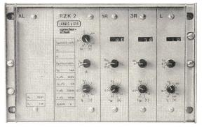
Relais für den Überstromschutz von Radial- und Ringnetzen sowie für den thermischen Schutz von Kabeln und Transformatoren im Spannungsbereich von 6-36 kV.
