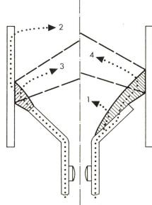
zu den Hörnerenden hochgeschoben hat, kommt es bei kräftig ausgebildeten Plasmastrahlen nicht oder nur zögend zum gewünschten alleinigen Stromfluss über den Pfad 2. Solange jedoch noch Strom über den Pfad 3 (bzw. 4) fliesst, bleibt das Löschsystem unwirksam, das einen vollständig über den Pfad 2 fliessenden Strom voraussetzt.
