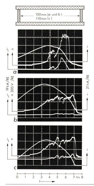
Fig. 2 Lichtbogenverlagerung bei planen Leitblechen (Kammerwandmaterial: Asbest)
