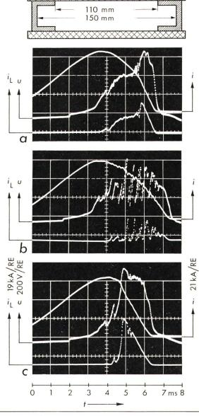
Fig. 4 Lichtbogenverlagerung bei U-förmigen Leitblechen Kammerwandmaterial:
