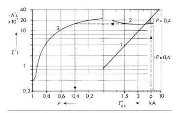
Ermittlung der Selektivitäts-Wahrscheinlichkeit bei einem prospektiven Kurzschlußstrom  $I''_{cc}$  von 6000 A, am Beispiel einer Kombination einer Sicherung und eines LS-Schalters
