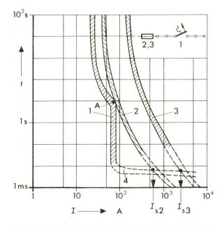
Fig. 4 Beispiel von empirisch ermittelten Auslöse-Kennlinien einer Selektivitäts-Kaskade
