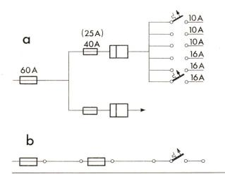
Fig. 1 Schaltung von Überstrom-Unterbrechern
