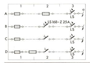
Fig. 7 Varianten von Selektivitätskaskaden
