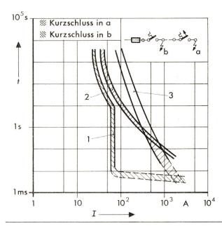
Fig. 8 Auslöse-Charakteristiken einer 3stufigen Selektivitätskaskade
