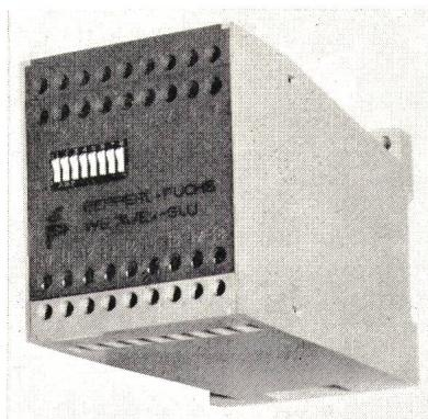
beträgt rund 5000 m. Das Gleichlaufüberwachungsgerät gibt ein Signal ab, wenn die Eingangsfrequenzen voneinander abweichen. Der signalauslösende Betrag der Abweichung kann im Bereich von 1 bis 31 % an einem Codierschalter im Gehäusedeckel binär eingestellt werden. Sollen mehr als 2 Drehzahlen miteinander verglichen werden, können mehrere Geräte zusammengekoppelt werden.
