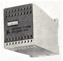
beträgt rund 5000 m. Das Gleichlaufüberwachungsgerät gibt ein Signal ab, wenn die Eingangsfrequenzen voneinander abweichen. Der signalauslösende Betrag der Abweichung kann im Bereich von 1 bis 31 % an einem Codierschalter im Gehäusedeckel binär eingestellt werden. Sollen mehr als 2 Drehzahlen miteinander verglichen werden, können mehrere Geräte zusammengekoppelt werden.
