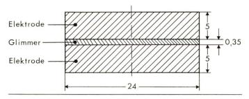
Fig. 11 Zylindrische Trennfunkenstrecke
