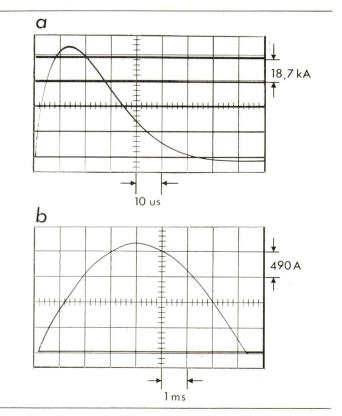
Fig. 4 Komponenten des Prüfstromes a Stoßstrom, b Langstrom
