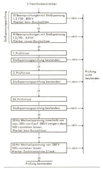
Fig. 6 Prüfverfahren für Trennfunkenstrecken
