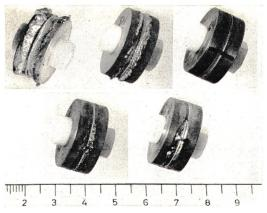
Fig. 12 Zylindrische Trennfunkenstrecken
