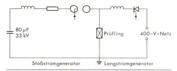
Fig. 3 Prinzipschaltung des Prüfstromgenerators
