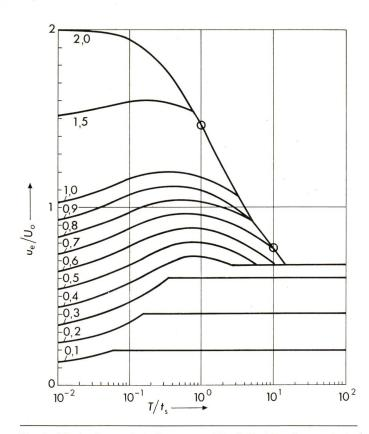
Fig. 4 Maximale normierte Spannung  $u_{\rm e}/U_0$  als Funktion der normierten Laufzeit  $T/t_{\rm S}$   $Z_1/Z_2=5,\ t_{\rm S}/t_{\rm R}=1/20,\ {\rm Parameter}\ U_{\rm AN}/U_0$
