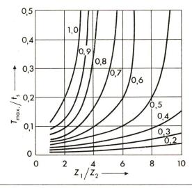
Fig. 10 Normierter Schutzbereich  $T_{\rm max}/t_{\rm S}$  als Funktion des Wellenwiderstandsverhältnisses  $Z_1/Z_2$  für die Wellenform 1/200 Parameter  $U_{\rm AN}/U_0$
