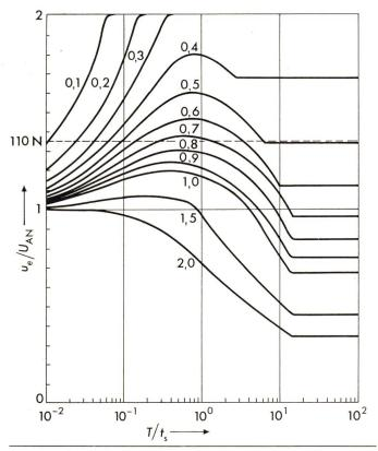
Fig. 6 Diagramm zur Bestimmung des Schutzbereiches  $Z_1/Z_2=5,\ t_{\rm S}/t_{\rm R}=1/20,\ {\rm Parameter}\ U_{\rm AN}/U_0$
