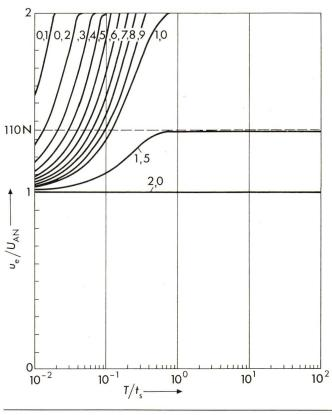
Fig. 7 Diagramm zur Bestimmung des Schutzbereiches  $Z_1/Z_2=1,\ t_{\rm S}/t_{\rm R}=1/20,\ {\rm Parameter}\ U_{\rm AN}/U_0$
