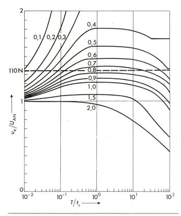
Fig. 8 Diagramm zur Bestimmung des Schutzbereiches  $Z_1/Z_2 = 5$ ,  $t_{\rm S}/t_{\rm R} = 1/300$ , Parameter  $U_{\rm AN}/U_0$
