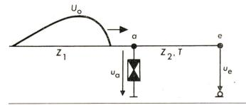
Fig. 1 Anordnung zur Berechnung des Schutzbereiches von Ableitern bei einem Ferneinschlag
