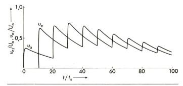
Fig. 3 Spannungsverlauf  $u_a$  am Leitungsanfang und  $u_e$  am Leitungsende ohne Ansprechen des Ableiters
