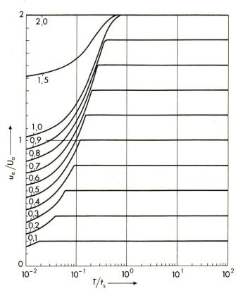
Fig. 5 Maximale normierte Spannung  $u_{\rm e}/U_0$  als Funktion der normierten Laufzeit  $T/t_{\rm S}$   $Z_1/Z_2=1,\; t_{\rm S}/t_{\rm R}=1/20,\; {\rm Parameter}\;\; U_{\rm AN}/U_0$
