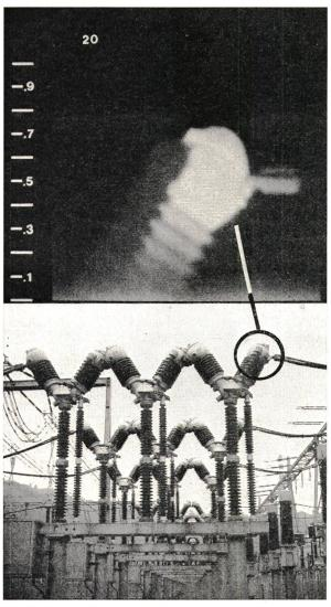
Fig. 3 Thermovisionsfoto von Schalterkopf 220 kV
