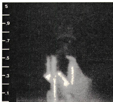
Fig. 2 Thermovisionsfoto von Trennerkontakt mit Isotherme Die weissen Zonen haben alle dieselbe Temperatur
