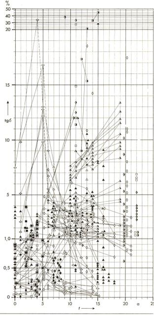
Fig. 1 Verlustfaktor tg $\delta$  (90 °C) in Abhängigkeit der Anzahl Betriebsjahre a
