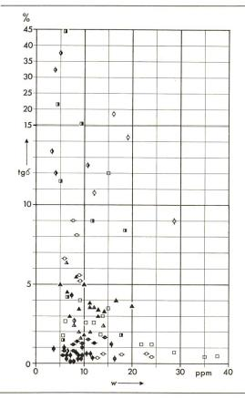
Fig. 3 Verlustfaktor tg $\delta$  (90 °C) in Abhängigkeit des Wassergehaltes w Erklärung der Symbole in Tabelle III. Zu beachten sind die zwei verschiedenen Maßstäbe für tg $\delta$
