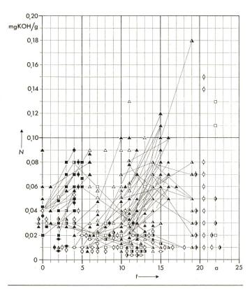
Fig. 4 Neutralisationszahl N in Abhängigkeit der Anzahl Betriebsjahre a Erklärung der Symbole in Tabelle III
