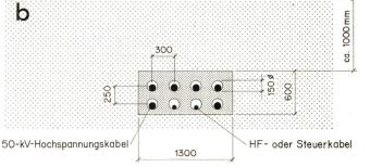
Fig. 5 Verlegen von Hochspannungskabeln
