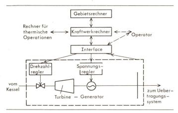
Fig. 2 Computerregelung eines Kraftwerkes
