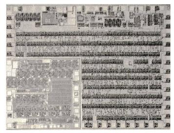
Fig. 5 Mikrophotographie eines Chips für digitale Armbanduhren (Grösse 4×5 mm)
