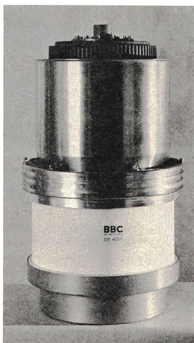
Fig. 2 Moderne Hochleistungs-Sendetetrode mit einer Ausgangsleistung von 1100 kW Höhe 670 mm max. Durchmesser 390 mm
