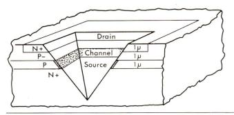
Fig. 4 Entlang den Kristallebenen angeätzte Siliziumscheibe (V-Groove), einen vertikalen MOS-Transistor ergebend
