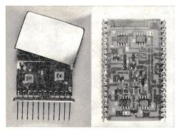
Fig. 7 Zwei Ausführungsformen von Dickschichtschaltungen
