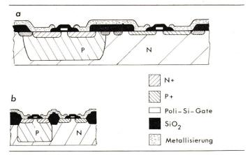
Fig. 3 Querschnitte a) durch einen konventionellen CMOS-Inverter und b) als Grössenvergleich durch einen LOCMOS-Inverter
