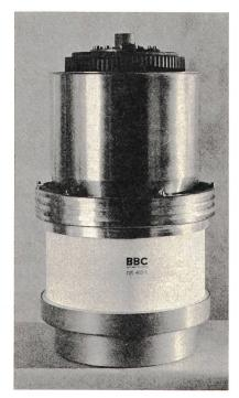
Fig. 2 Moderne Hochleistungs-Sendetetrode mit einer Ausgangsleistung von 1100 kW Höhe 670 mm max. Durchmesser 390 mm
