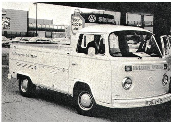
Fig. 1 VW-Elektrotransporter
