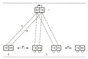
Fig. 2 2-Frequenz-Simplexnetz
