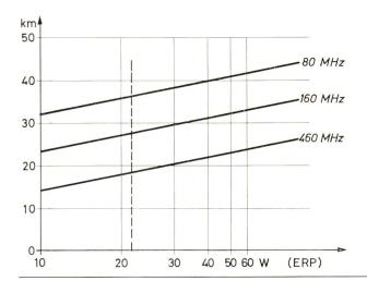
Fig. 6 Reichweite in Funktion der Sendeleistung für die Bänder 80, 160 und 460 MHz
