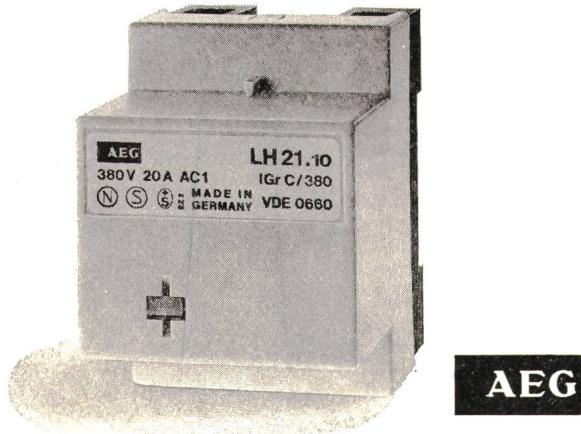
Der LH 21 ist für 220 V 50 Hz Steuerspannung ausgelegt und hat für die Stromversorgung der Spule einen eingebauten Gleichrichter. Darum ist der LH 21 brummfrei.
