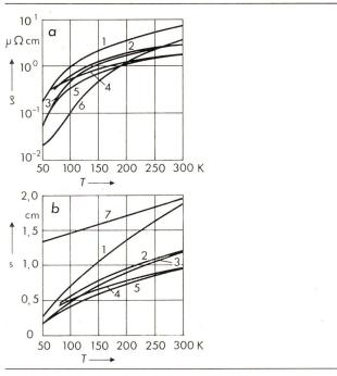
Fig. 2 Spezifischer Widerstand  $\varrho$  und Skin-Eindringtiefe s von Metallen im Temperaturbereich 50...300 K
