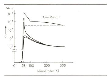
Fig. 4 Metallische Leitfähigkeit von TTF-TCNQ-Salzen als Funktion der Temperatur
