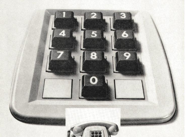
Der Telephonapparat TS 70 TP ist eine moderne Station. Er kann ohne zusätzliche Massnahmen anstelle eines Apparates mit Wählscheibe angeschlossen werden.
