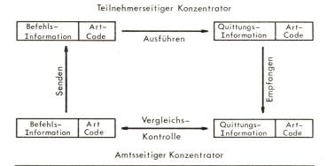
Fig. 8 Fehlererkennung bei der Informationsübertragung
