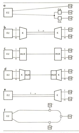
Fig. 1 Möglichkeiten zur besseren Ausnutzung des Teilnehmerleitungsnetzes
