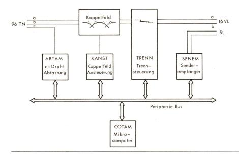
Fig. 2 Hardwareauf bau des Konzentrators
