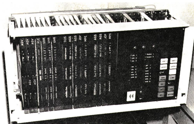
Fig. 6 Zeitimpulsgeber ZG 73 zur Erzeugung von Taximpulsen für die schweizerische PTT
