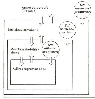
Fig. 4 Verschachtelung von Prozessorfunktionen SW Software
