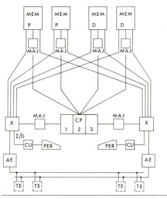
Fig. 4 Blockschema des Prozessorsystems mit redundanter Konfiguration (Bezeichnungen siehe im Text)
