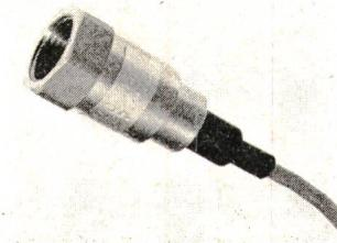
3/8" Gasrohrgewinde. Druckbereiche 0...2 bis 0...400 bar. Genauigkeit 0,2...0,5 %. Hohe Stabilität und Eigenfrequenz, Auflösung von 0,1 mbar. Das robuste Gerät ist für Einsatz in extremen Umweltbedingungen geeignet. Temperaturbereich von -40...120 °C.
