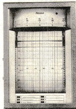
Widerstandsthermometer, Thermoelemente oder Geber mit Strom-, Spannungs- oder Widerstandsausgang. Der Meßstellen-Umschalter ist mit speziellen Goldkontakte bestückt und in einem vollgekapselten Gehäuse untergebracht. Der Papierantrieb erfolgt durch einen Synchronmotor für 220 V oder 24 V. Die Schreiber können mit Minima- und Maxima-Grenzkontakte ausgerüstet werden und sind lieferbar für Schalttafeleinbau und als tragbare Geräte.
