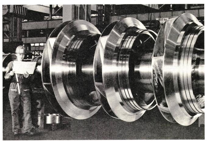
Zwei Speicherpumpen für das Kraftwerk Châtelard, Schweiz. Zusammenbau des Pumpenrotors. Förderhöhe 274 bis 447 m, Leistung 35 817 bis 37188 kW, Drehzahl 600 U/min.
