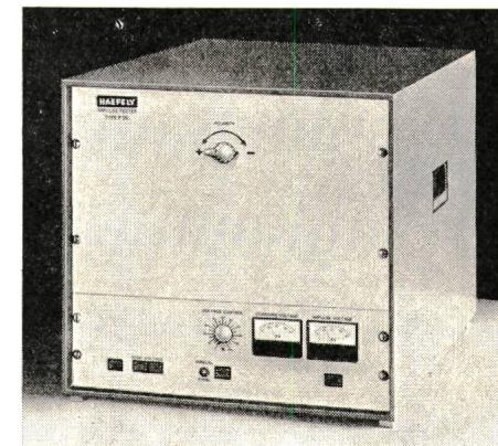
und im Fertigungsbereich für die routinemässige Qualitätskontrolle. Er prüft Apparate und Bauteile mit genormten Stoßspannungen (1,2/50  $\mu$ s) bis ca. 32 kV, mit einer maximalen Energie von 100 J. Die Ladespannung ist stufenlos einstellbar. Die tatsächliche Ausgangsspannung wird direkt am eingebauten Stoßspannungsvoltmeter abgelesen. Die Betriebsweise ist wählbar: automatisch repetierend 6/min oder Einzelauslösung.
