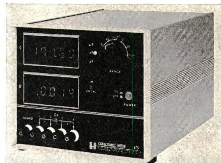
mit einer Messgenauigkeit von 0,0005. Die Messung erfolgt vierdrähtig bei 1 kHz. Im Handbetrieb kann etwa 1 Messung pro Sekunde ausgeführt werden, in automatischen Messstationen bis 5 Messungen pro Sekunde.
