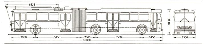
Fig. 2 Croquis d'encombrement du trolleybus selon fig. 1
