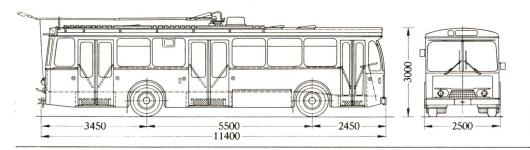
Fig. 3 Croquis d'encombrement du trolleybus à deux essieux du type «unifié UST»
