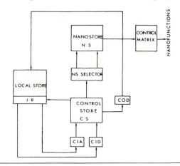
Aufbau der QM-1-Maschine
