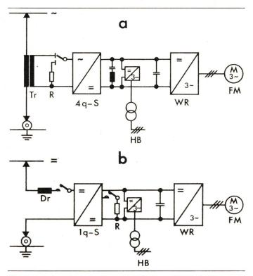
Fig. 6 Prinzipschaltbild der Drehstromlokomotive für Wechselstromnetze (a) und für Gleichstromnetze (b)
