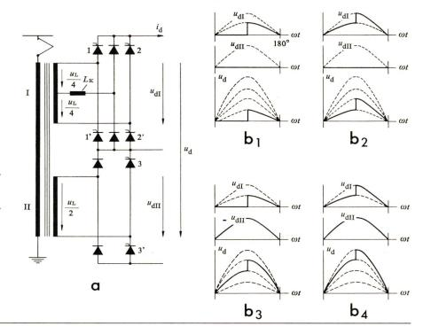
Fig. 2 Vierstufige Stromrichter-Sparschaltung mit Zusatz-Kommutierungsdrosselspule
