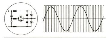
Fig. 5 Schaltung einer Wechselrichterphase und Arbeitsweise des Unterschwingungsverfahrens
