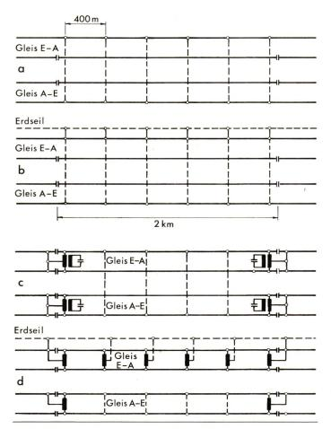
Fig. 7 Prinzipschaltungen der untersuchten Schienenstromkreise
