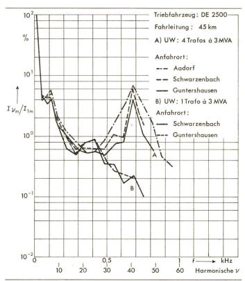
Fig. 4 Einfluss der Unterwerkleistung und des Anfahrortes auf den Oberwellengehalt des Fahrleitungsstromes im Unterwerk  $I_{\rm Vm}/I_{\rm 1\,m}$
