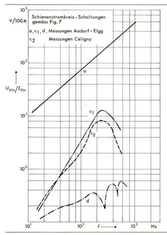
Einfluss der Schienenstromkreisschaltungen Fig. 9 auf die Störspannung am Gleis (maximale Störspannungsamplitude  $U_{\rm vm}$ bezogen auf den Gleisstrom Ivm)
