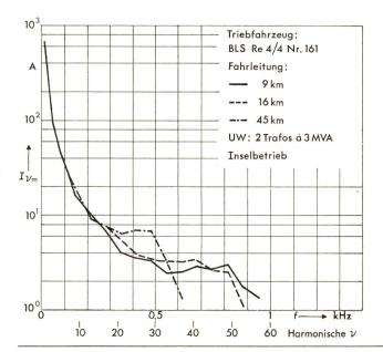
Fig. 6 Einfluss der Fahrleitungslänge auf den Fahrleitungsstrom im Unterwerk (maximale Oberschwingungsamplitude  $I_{Vm}$ )
