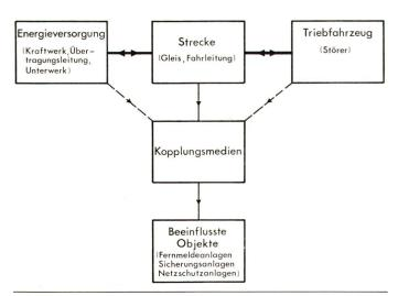
Fig. 1 Blockschema der Netzrückwirkungen und der Störbeeinflussungen
