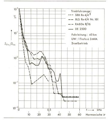
Fig. 3 Einfluss der Triebfahrzeugbauart auf den Fahrleitungsstrom im Unterwerk (maximale bezogene Oberschwingungsamplituden  $I_{\rm Vm}/I_{\rm 1\,m}$ )
