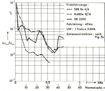
Fig. 8 Einfluss der Triebfahrzeugbauart auf die Störspannung am Gleis (maximale bezogene Oberschwingungsamplitude  $U_{\rm Vm}/U_{\rm 1m}$ )
