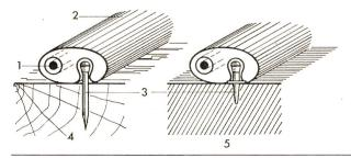
Fig. 2 Linienleiterkabel mit Befestigung [3]
