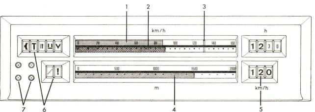
Fig. 5 Anzeigegerät in einem Führerstand des Triebfahrzeugs
