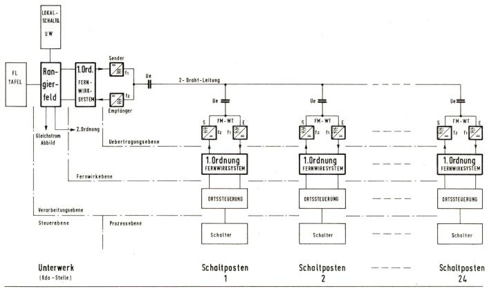
Fig. 2 Linienstruktur, Fernwirksystem 1. Ordnung nach funktionellen Schnittebenen geordnet
