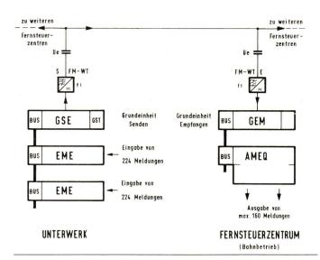
Fig. 7 Meldesystem 2. Ordnung, Komponenten im Unterwerk und in einem Fernsteuerzentrum
