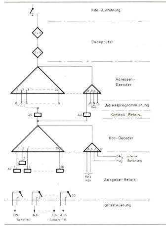
Fig. 6 Blockschema der Kommandodecodierung in einer Aussenstelle
