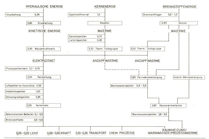
Fig. 2 Möglichkeiten und ungefähre Wirkungsgrade der Energiegewinnung, -umwandlung und -speicherung
