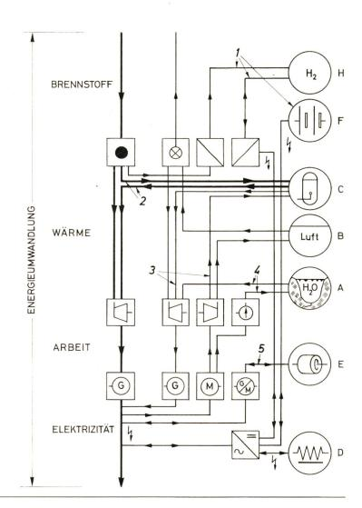
Fig. 1 Spitzenlastdeckung durch Speicherung von Sekundärenergie (aus [2])
