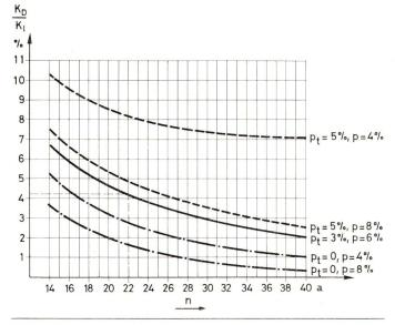
Fig. 2 In einem Jahr sich rentierende Kosten des Doppelstockschutzes (v = 1)
