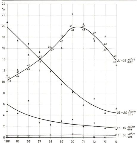
Fig. 1 Prozentanteile der pro Jahr aus jeder Altersklasse ersetzten faulen Stangen
