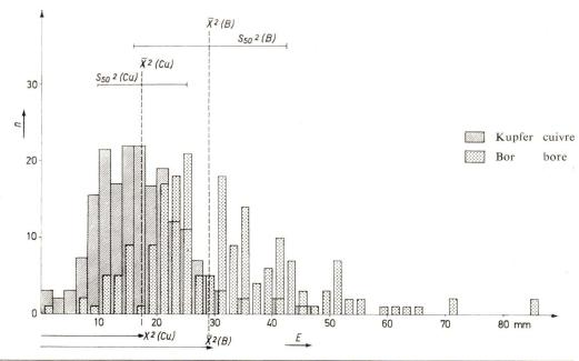
Fig. 2 Verteilung der Eindringtiefen des Kupfer- und Borsalzes bei 192 Masten, die im Wechseldruckverfahren mit CKB-Salz imprägniert wurden.
