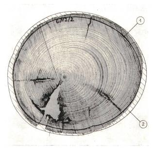
Fig. 4 Mastquerschnitt mit starker Lenzites-Fäule an Schwindriss. Partiell starke Schälverluste vorhanden:
