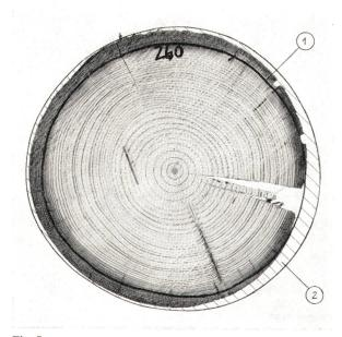
Fig. 5 Mastquerschnitt ohne Vermorschungsschaden, aber mit partiell starken Schälverlusten:
