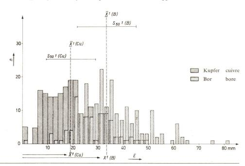
Fig. 1 Verteilung der Eindringtiefen des Kupferund Borsalzes bei 204 Masten, die im Trogsaugverfahren mit CKB-Salz imprägniert wurden.
