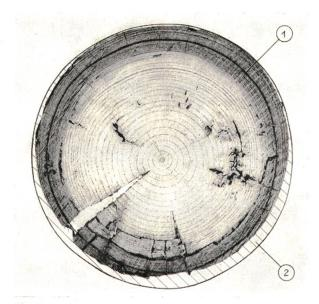
Fig. 3 Mastquerschnitt mit Vermorschungsschäden im schutzmittelfreien Kern, die durch Infektionen über Schwindrisse verursacht wurden.
