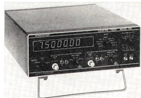
Ein Read Only Memory (ROM) steuert die Funktion, den Dezimalpunkt sowie die zugehörige Einheit. Der Z-Ausgang erlaubt die Beobachtung der Triggerschwelle des Modells 150 an einem Oszilloskop. Dank der hohen Eingangsempfindlichkeit von 10 mV an 1 MΩ Eingangsimpedanz können auch kleinste Signale ohne Zwischenverstärker direkt gemessen werden. Für den Anschluss eines ebenfalls lieferbaren Druckers ist ein BCD-Ausgang vorgesehen.
