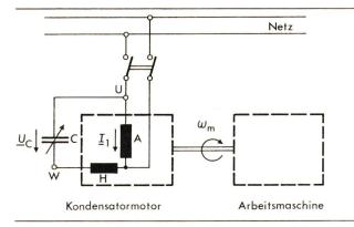
Fig. 1 Schaltung eines Kondensatormotors
