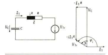
Fig. 2 Ersatzschaltbild und Zeigerdiagramm für synchronen Betrieb
