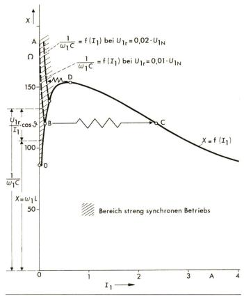
Fig. 4 Blindkomponente der Maschinenimpedanz als Funktion des Stromes
