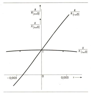
Fig. 6 Wirk- und Blindkomponente der Maschinenimpedanz als Funktion des Schlupfes (× ... Messwerte)
