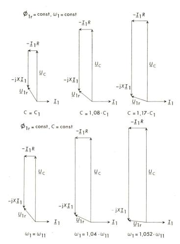
Fig. 5 Zeigerdiagramme für synchronen Betrieb
