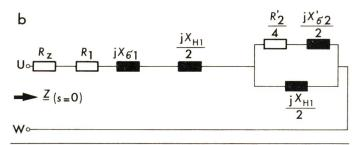
Fig. 3 Ersatzschaltung zur Bestimmung der Eingangsimpedanz
