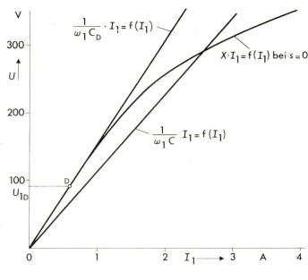
Fig. 7 Stromabhängiger Verlauf von Kondensatorund Maschinenspannung
